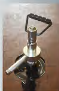
Fixer la tige de piston avec écrou d'origine
