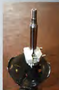
Monter les vis de serrage (en fonction du Ø de la tige du piston) sur la mâchoire de serrage
