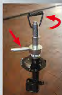
Serrer les mâchoires pour maintenir la tige de piston en place
