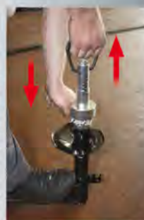
Tirer sur le tube télescopique en pivotant légèrement de gauche à droite pour le verrouiller. Pour les ressorts d'arrêt, dont la résistance est trop importante, il est possible de sortir la tige de l'amortisseur de 20 mm supplémentaire en maintenant le bas de la jambe de force et en tirant sur la tige.
