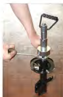
Déverrouiller le tube télescopique en le pivotant de gauche à droite
