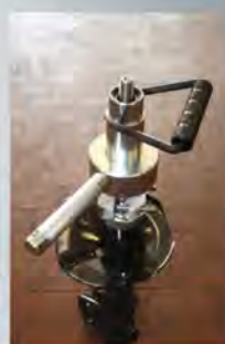
Visser l'unité télescopique de base dans le support intermédiaire et positionner de l'ensemble sur l'amortisseur
